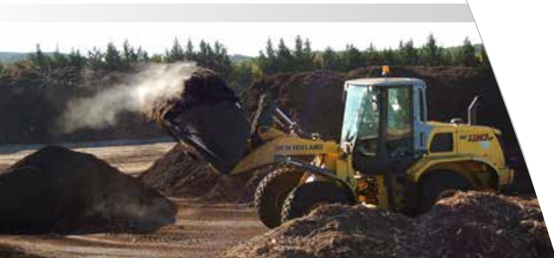
Chargeur sur une plateforme de compostage
